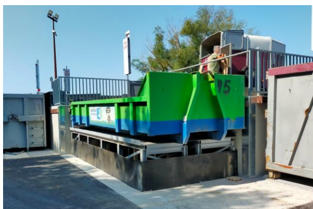
Figure 20 : Exemple d'une rehausse pour benne à gravats
